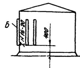
2. Под ребра жесткости устанавливают домкраты. Резервуар поднимают выше осадки на 40-60 мм.
