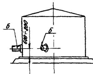
2. С помощью трубоукладчика Q-60 тс резервуар поднимается за один из патрубков на высоту, превышающую величину осадки на 40-60 мм.
