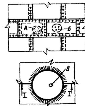
3. Группу точечных углублений А, расположенных у заклепочных полей, исправляют в соответствии с требованиями п. 2 с дополнительной подгонкой в один уровень подкладок Г, привариваемых герметичным швом к днищу и к листу.
