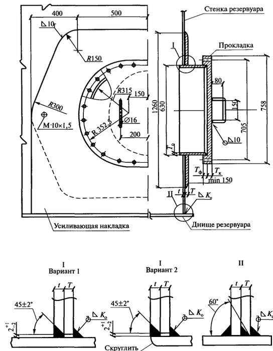
Рис. 3.11. Люк-лаз овальный 600 × 900 мм в I поясе стенки.
