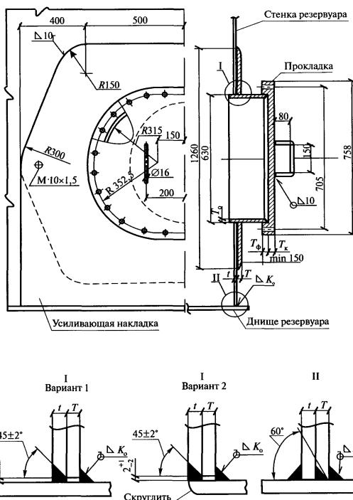
Рис. 3.11. Люк-лаз овальный 600 × 900 мм в I поясе стенки.
