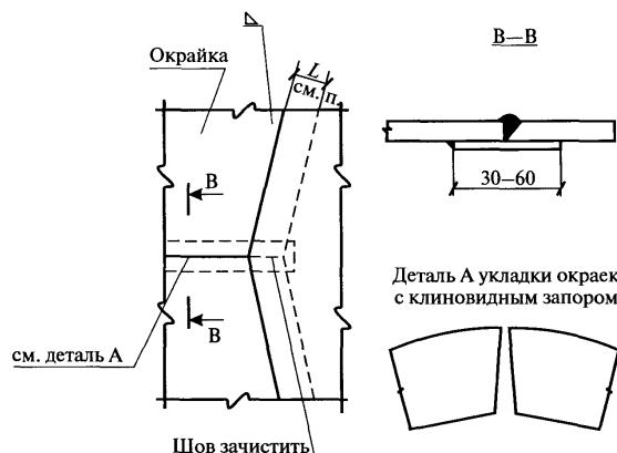
Рис. 3.5. Соединение центральной части с окрайками днища
