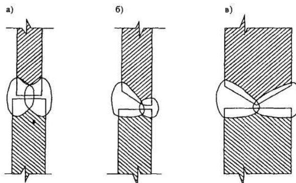
**Рис. 3.2.** Горизонтальные стыковые соединения стенки:
