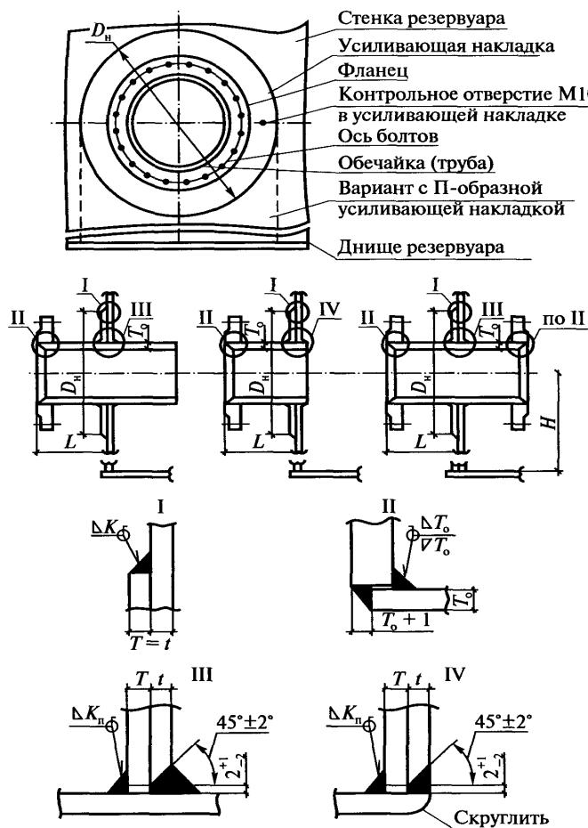
Рис. 3.9 Общий вид патрубка в стенке резервуара
