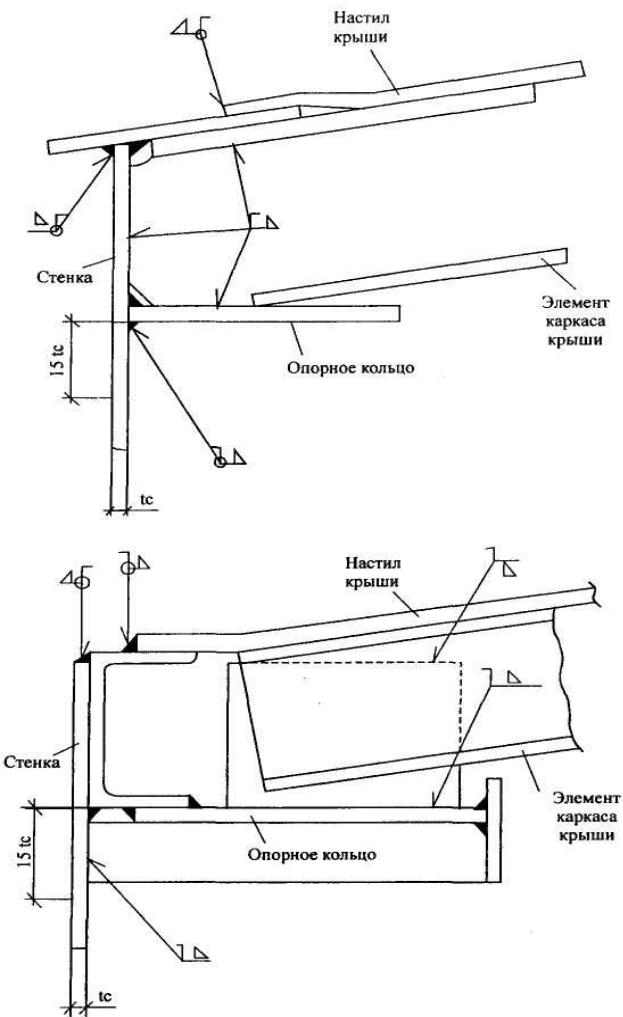
Рис. 3.8. Соединение сферической крышки со стенкой
