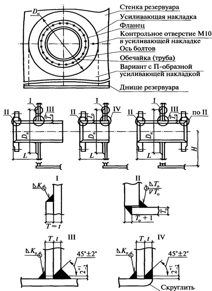
Рис. 3.9 Общий вид патрубка в стенке резервуара
