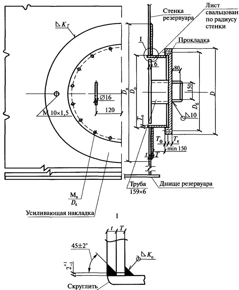
Рис. 3.13. Люк-лаз круглый в III пояссе стенки (резервуар с pontоном)
