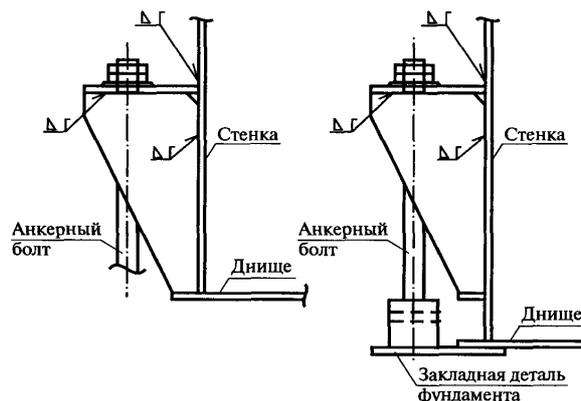
Рис. 3.16. Анкерное крепление стенки
