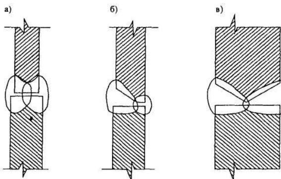
**Рис. 3.2.** Горизонтальныестыковые соединения стенки:
