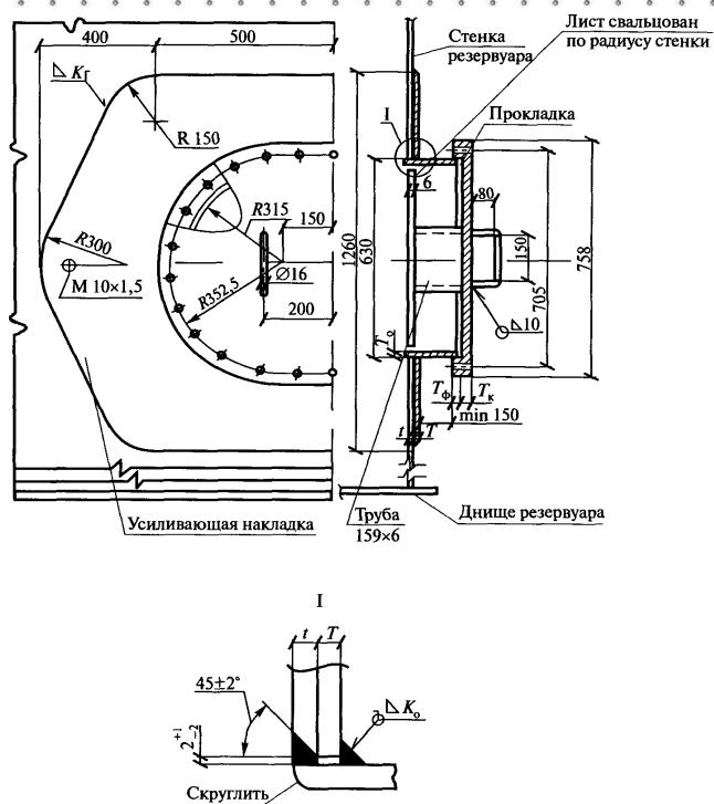
Рис. 3.12. Люк-лаз овальный в III пояссе стенки (резервуар с pontоном)
